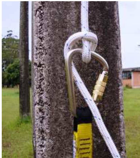
Figura 15 – Ajuste do nó de freio
