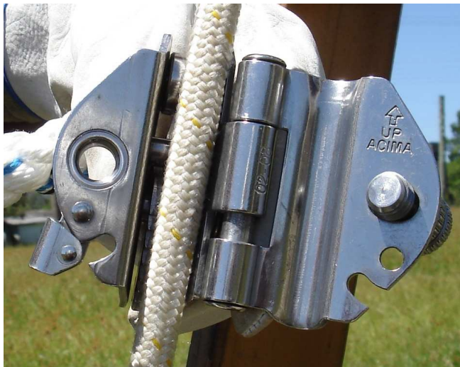
Figura 33 – Instalação do trava-quedas na linha de vida
