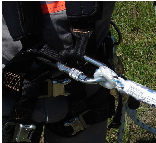
Figura 34 – Instalação do trava-quedas no cinto paraquedista
